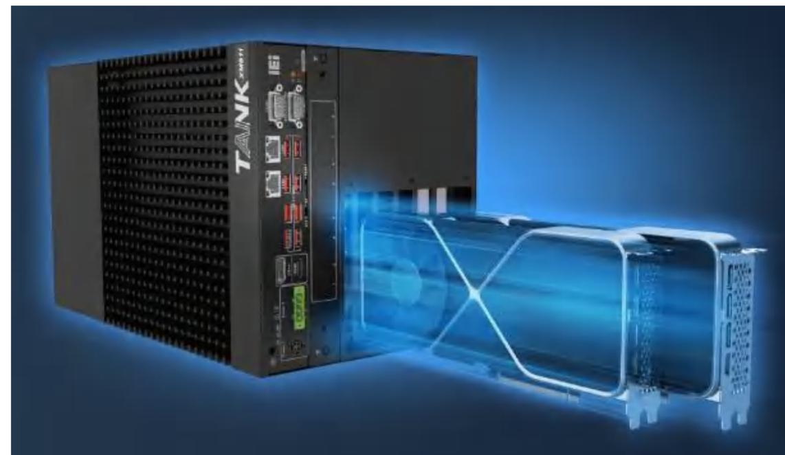
在创新性上，iEi威强电TANK-XM811模块化设计，对于客户来说，不同的产品线可以用同一产品进行配置，保证产品的一致性。此外采用独特的冷锻散热结构，使用鳍片散热器概念实现更好的热传导。这增强了二维热传导并降低了流动阻抗，从而在该无风扇系统中实现了更好的散热。整体重量和尺寸因此减小，这显著提高了在振动敏感应用（如AGV）中的系统可靠性。此外，这种创新的散热设计使TANK-XM811能够最大限度地提高性能，优于传统的由平行散热片组成的散热器。
