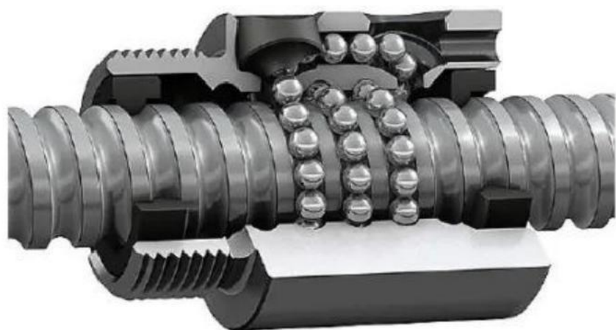
图 5 8：滚珠丝杠结构示意图
