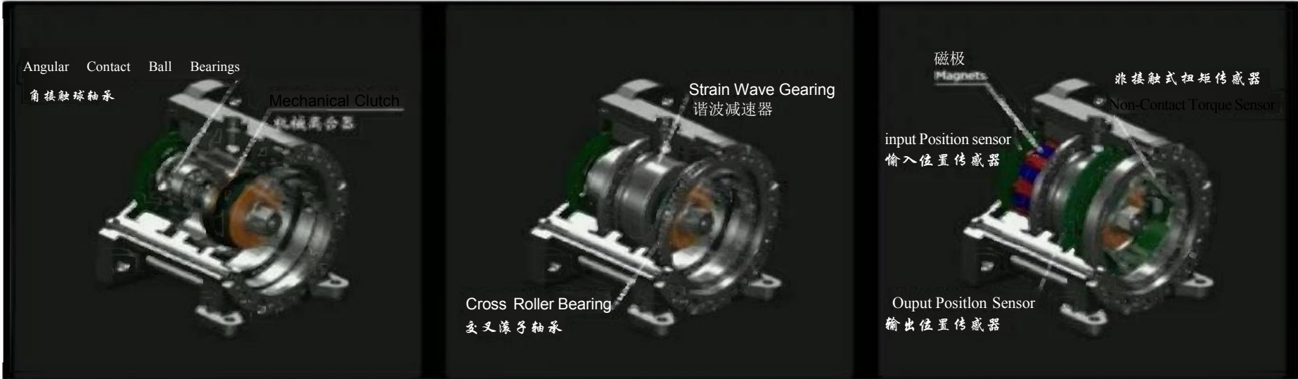
图46: 谐波减速器是特斯拉Optimus 旋转执行器的核心零部件
