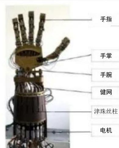
图16: 空间五指灵巧手结构设计
