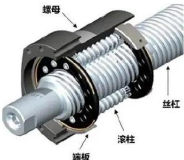
图 5 5：行星滚柱丝杠结构示意图
